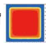
相対放射照度分布 LWD:5mm 放射照度 150mW/cm 2 =LWD5mm時
