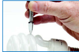
接触子を変えることでR形状部の厚さ測定にも対応
