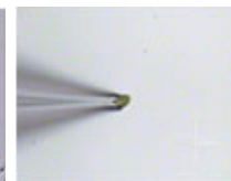
10μm異物の真空吸着
